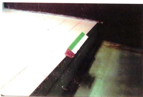
写真-2 海域へ転落するコンテナ (Case8, 半載コンテナ, x_c=50.5\text{cm} , x_{ob}=80.5\text{cm} )
