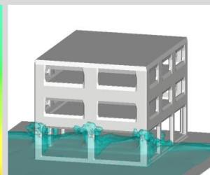
陸上構造物に作用する津波力
